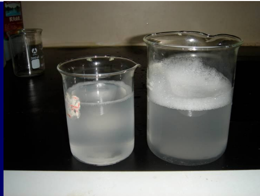
100ppm白油原始溶液(左)与通气后溶液(右)的对比
