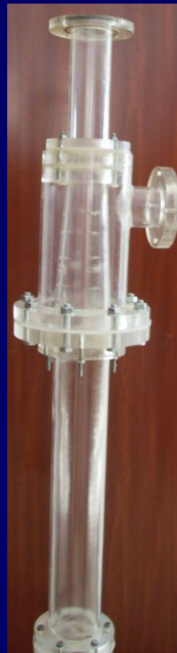
使用叶片导流和旋转射流取水技术
